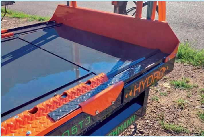
Verlängerung vorne hydraulisch mit Teleskopboden
