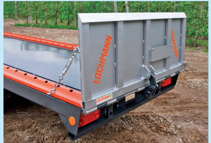
Rampe hinten hydraulisch (180° Öffnungswinkel)
