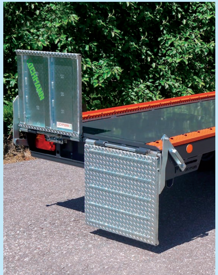
Rampe mechanisch mit Schnellverriegelung
