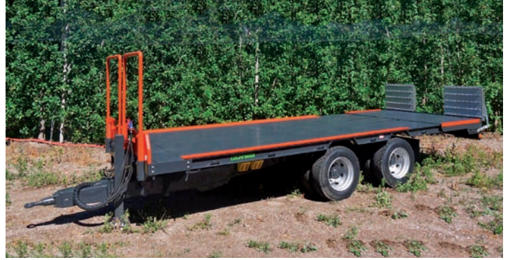
Gesamtgewicht 14.000kg - Brücke 2.300x5.000mm Verlängerung vorne mechanisch + hinten hydraulisch
