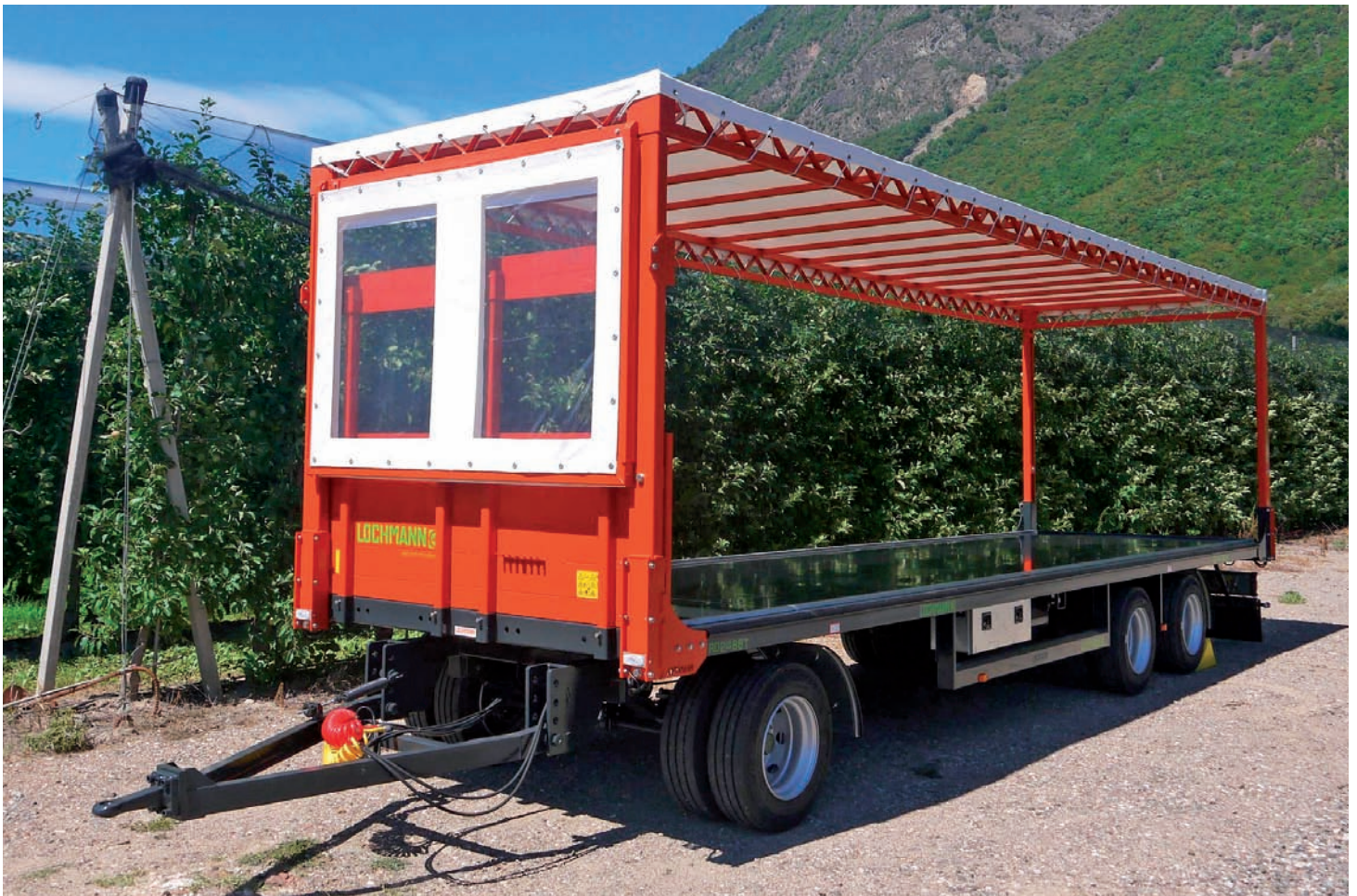
Gesamtgewicht 24.000kg - Brücke 2.300x8.600mm mit hydraulischem Hubdach
