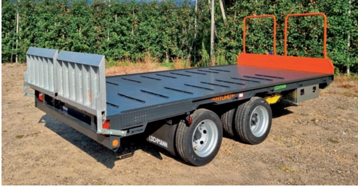
Gesamtgewicht 14.000kg - Brücke 2.300x5.000mm Verlängerung hinten hydraulisch Teleskopboden
