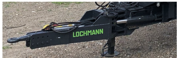
RFT 120 T Piano di carico chiuso assale motrice - timone di sterzo idraulico
