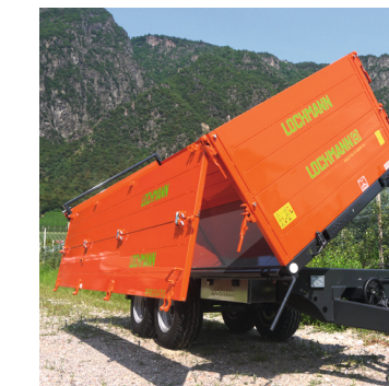
KIPPMATIC, comando centrale del ribaltabile. (brevettato)
