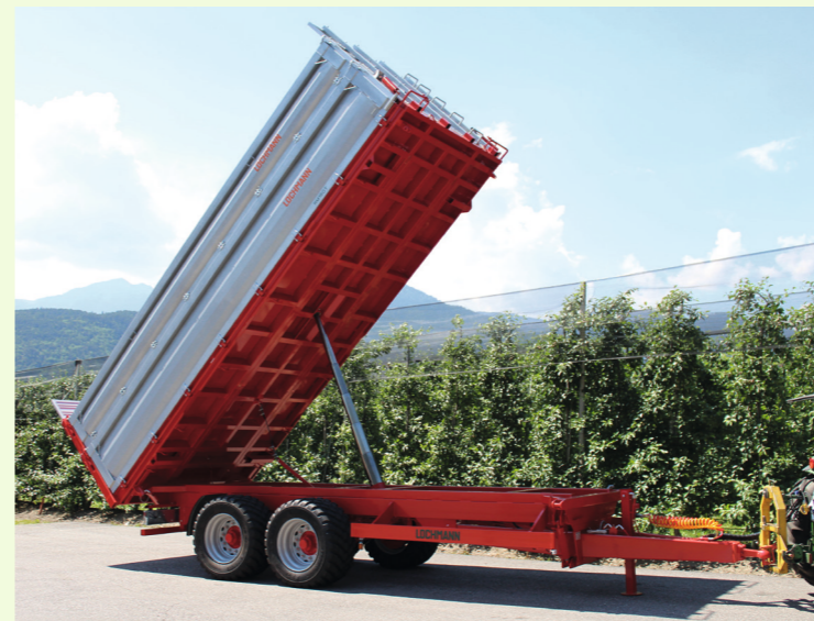
RM 180 T timone con sospensione idraulica
