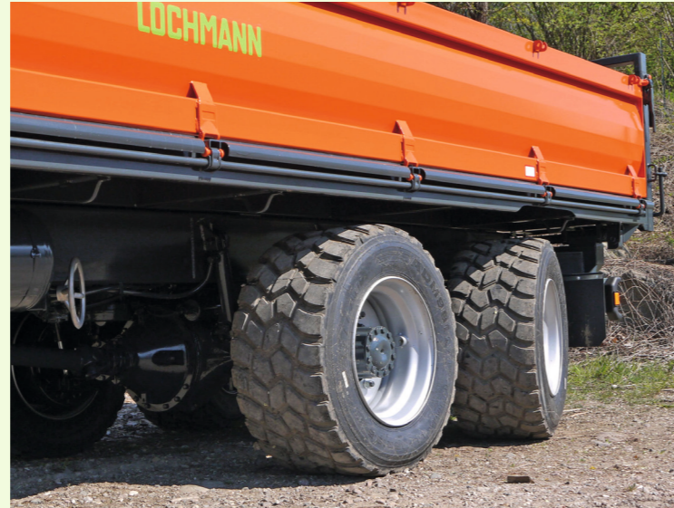
Assale posteriore autosterzante o con sterzata a comando
