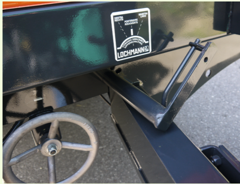
Comando centrale del ribaltabile LOCHMANN-KIPPMATIK
