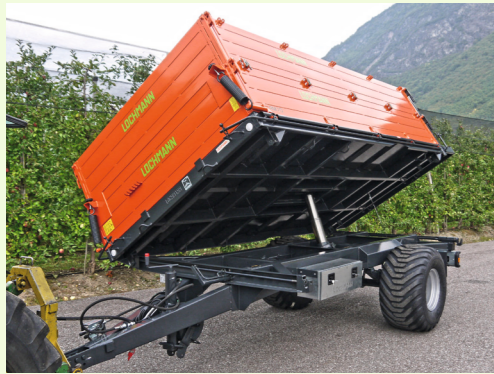
Ribaltamento con cilindri telescopici con alta capacità di sollevamento
