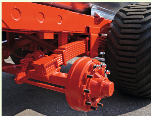
Assali Tandem "Bogie" balestrati con bilanciere
