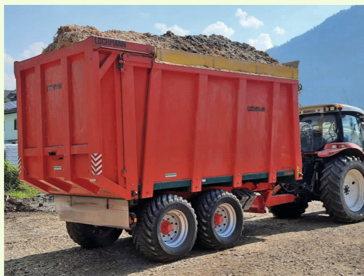
ASW 14.50 con scarico a spinta
