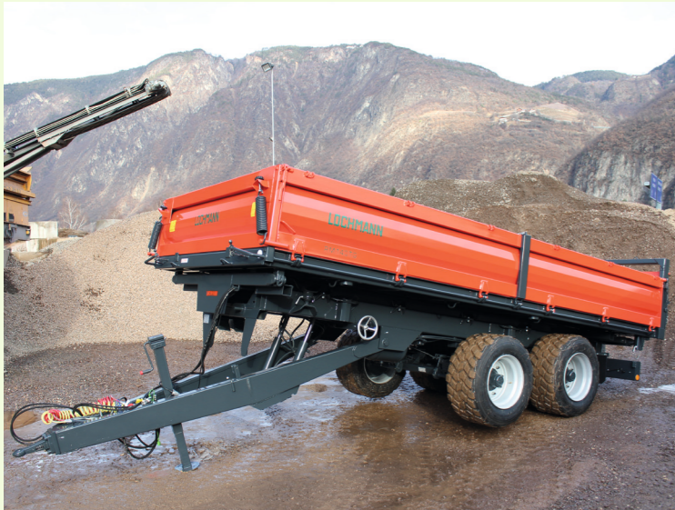
Timone ammortizzato / pianale inclinabile idraulicamente
