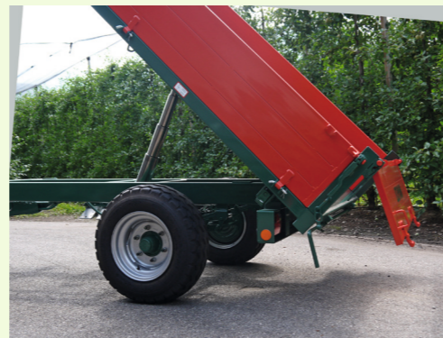
Sponda posteriore con chiusura centralizzata, apribile sotto e sopra (escl. RM15-25)
