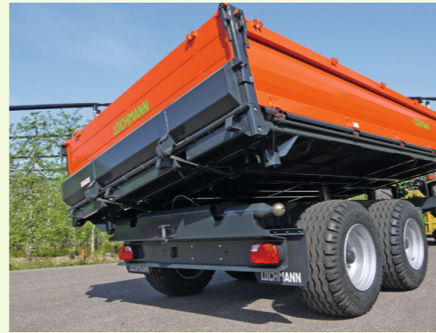
Robuste cerniere a sfera per ribaltamento con Kippmatik integrato (brevettato pendente)
