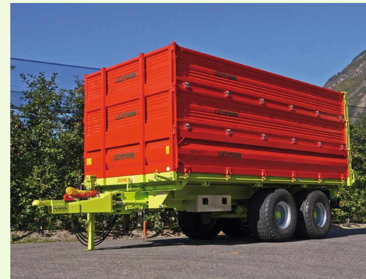
RM 140 T con timone sterzante idraulico
