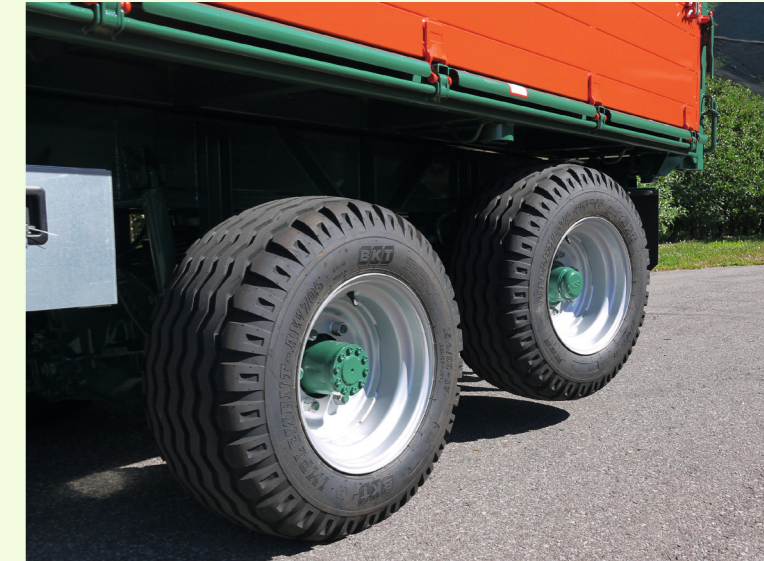
Assale alzabile idraulicamente
