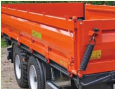
Die Modellreihen ab 140 T: Stärker als je zuvor mit 60 mm starken Spezialbordwänden und versenkten Verschlüssen
