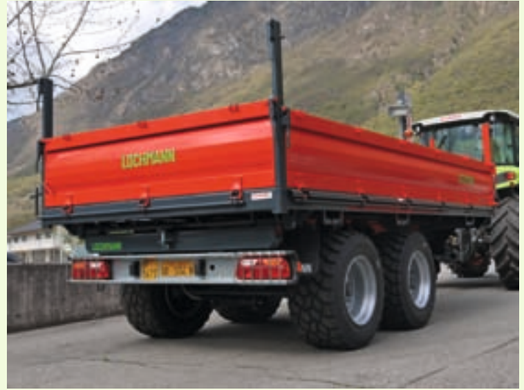
RM 140 T mit Stehern für Holzaufsatzwände
