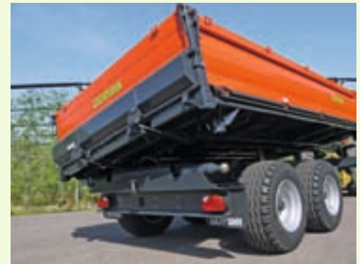
Starke Kugel-Kippklager mit integrierter Kippmatik (Patentiert)
