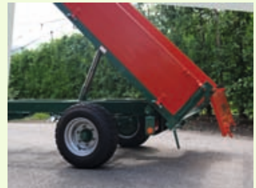
Rückwand mit Zentralverriegelung, oben und unten zu öffnen (ausg. RM15-25)
