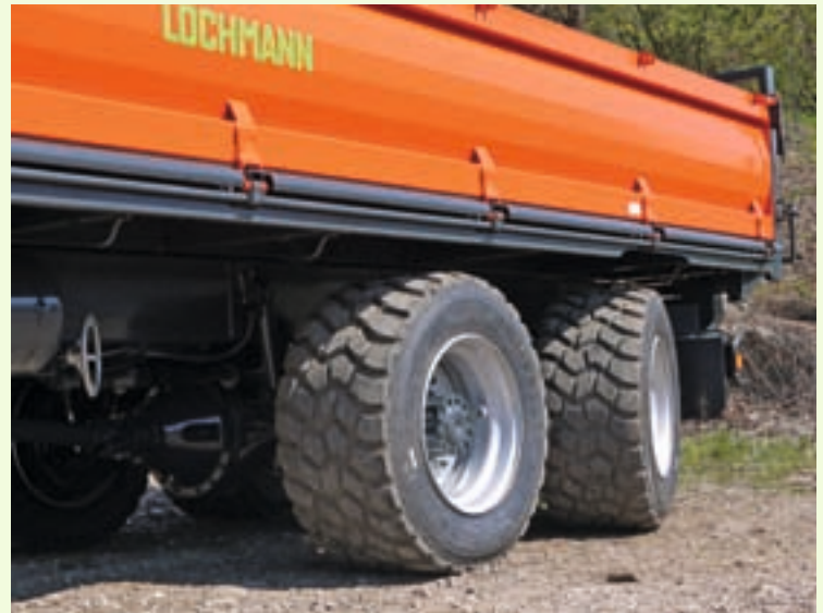
Lenkachse als Nachlaufachse oder mit Zwangslenkung
