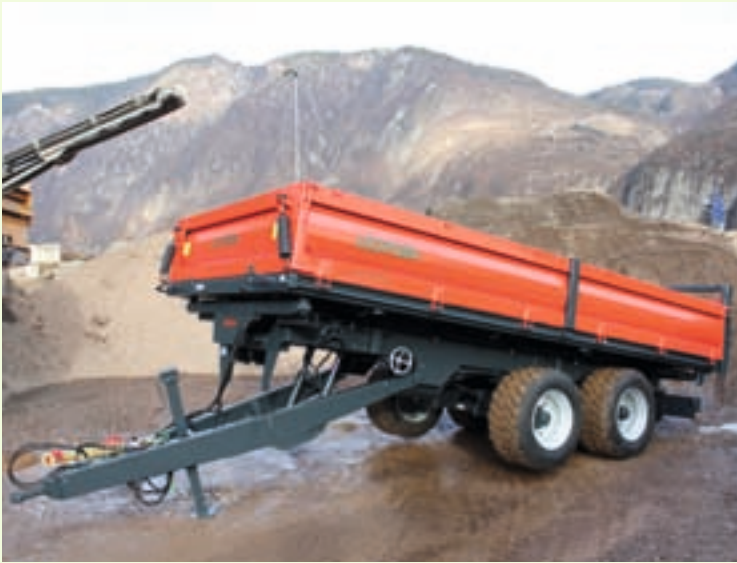
Deichselfederung / Brücke hydraulisch schwenkbar
