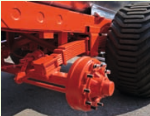
Tandem Modelle: mit Bogie-Aufhängung pendelnd und gefedert
