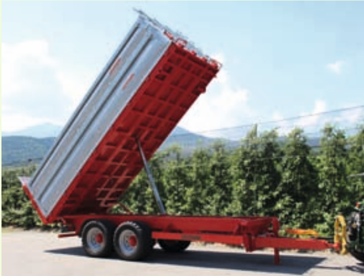
RM 180 T mit hydraulischer Deichselfederung
