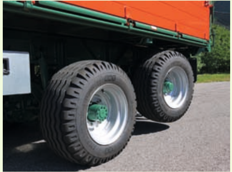
Liftachse (Achse hydraulisch heben)
