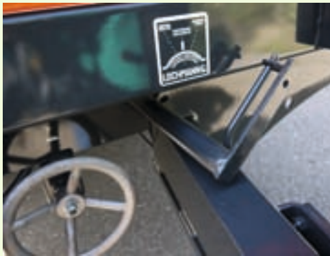
LOCHMANN KIPPMATIK, zentralisierte Kippklagersteuerung (Patentiert)
