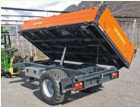
Geschützte Lichtanlage im Stahlträger integriert (bis Breite 2000 mm)
