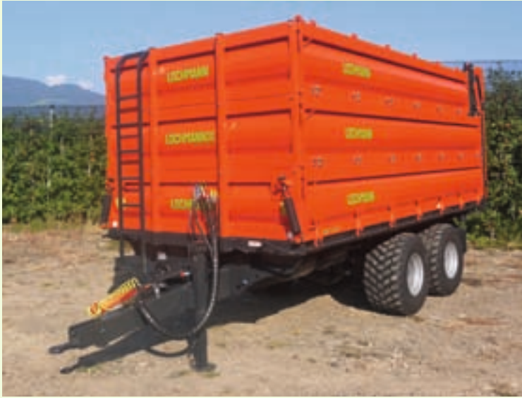
RM 140 T mit polygonalen Stahlbordwänden und Aufsatzwänden
