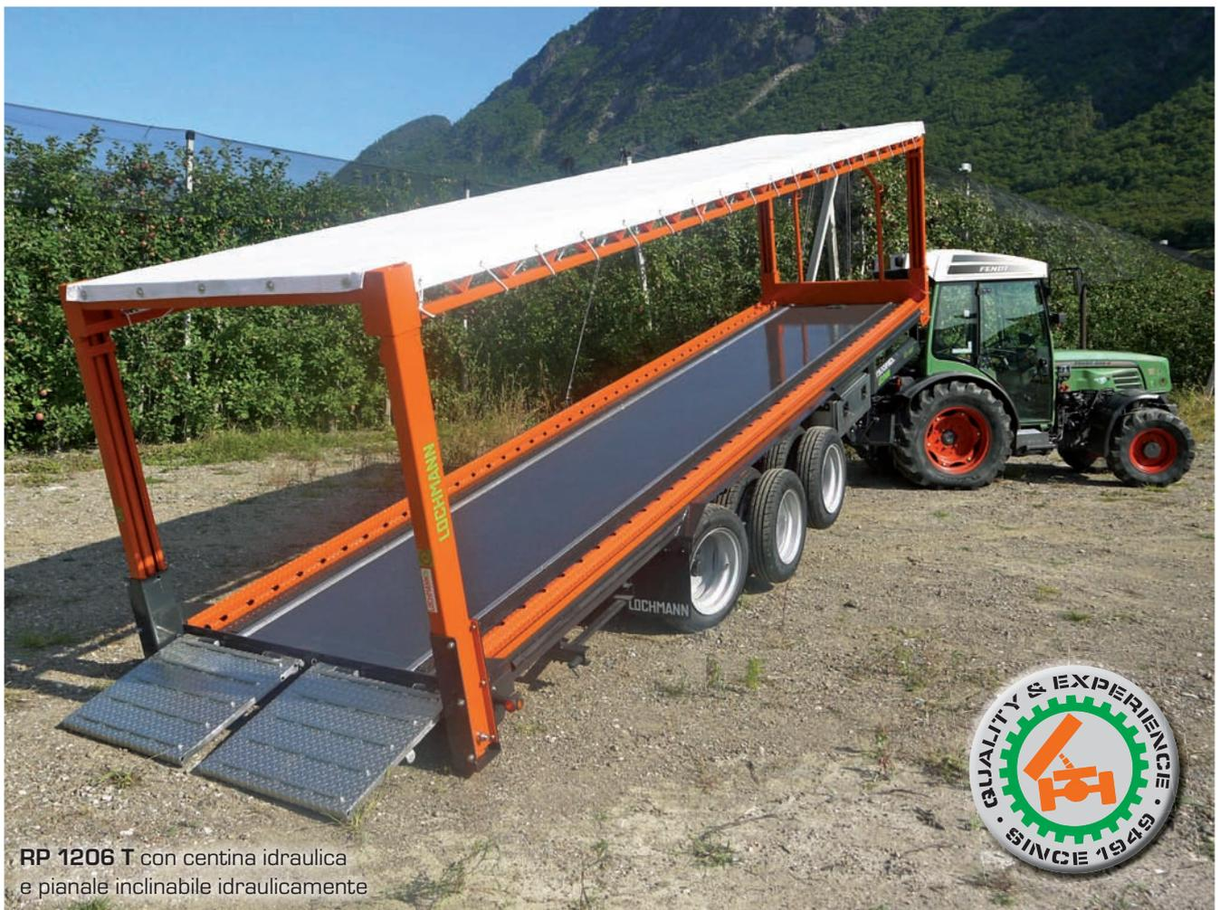
RP 1206 T con centina idraulica e pianale inclinabile idraulicamente
