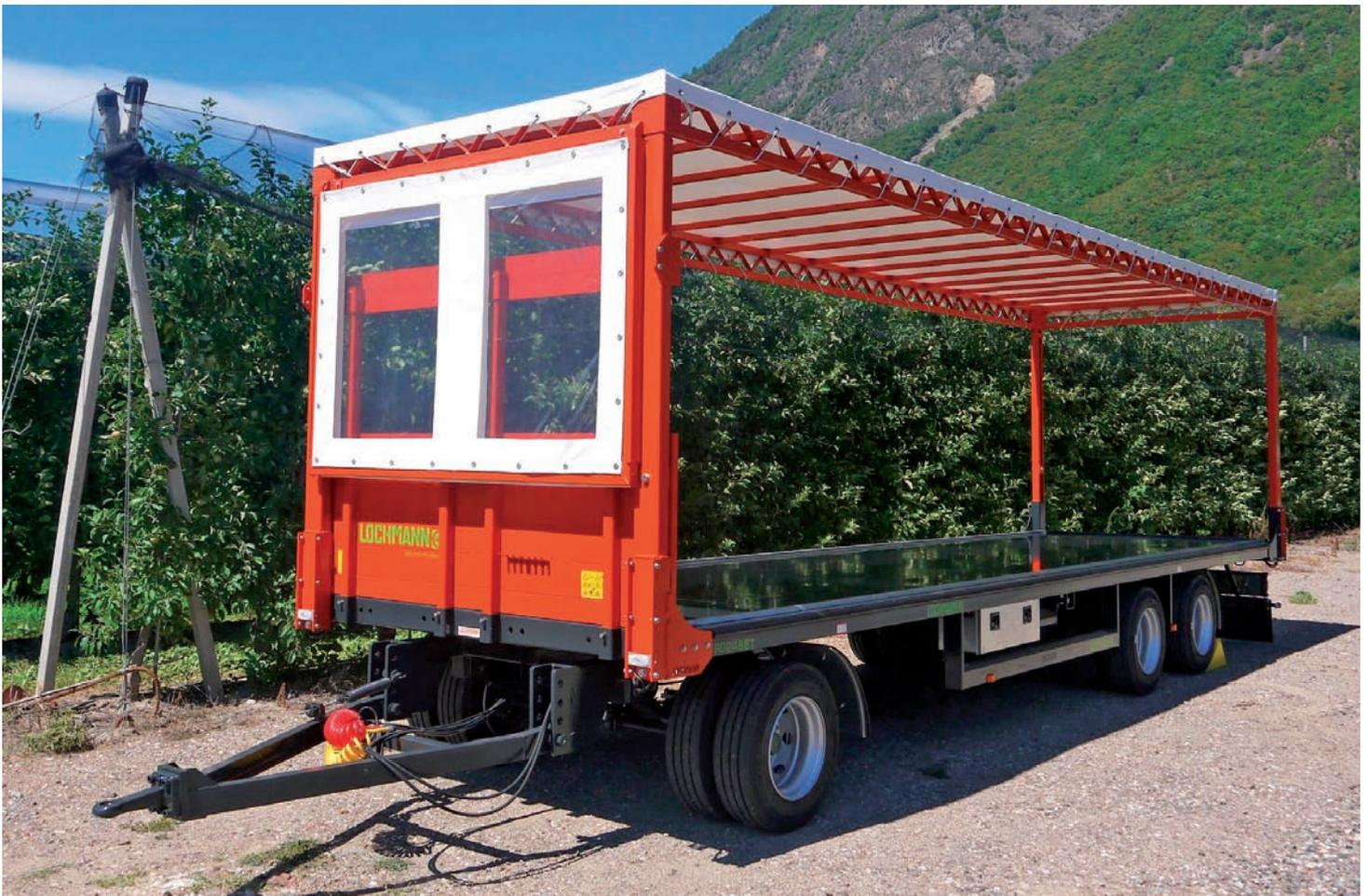
**Omologazione 24.000kg - pianale di carico 2.300x8.600mm con centina idraulica**
