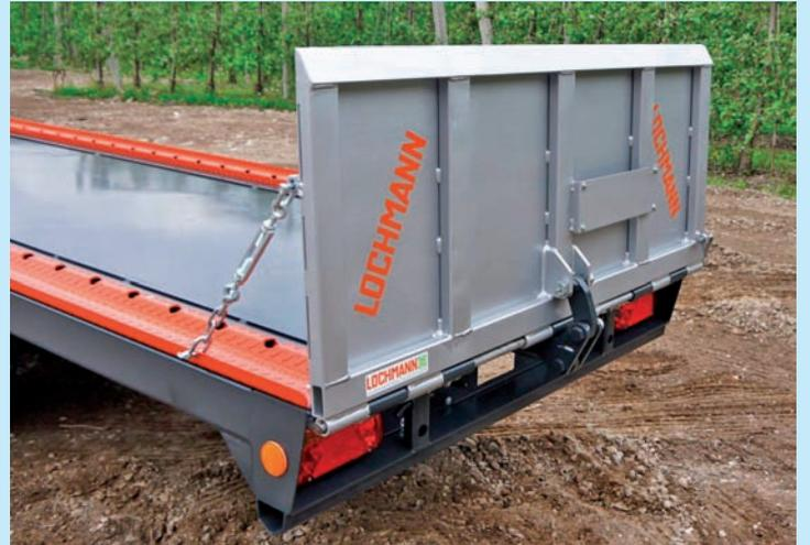
Rampa posteriore idraulica (angolo di apertura 180°)
