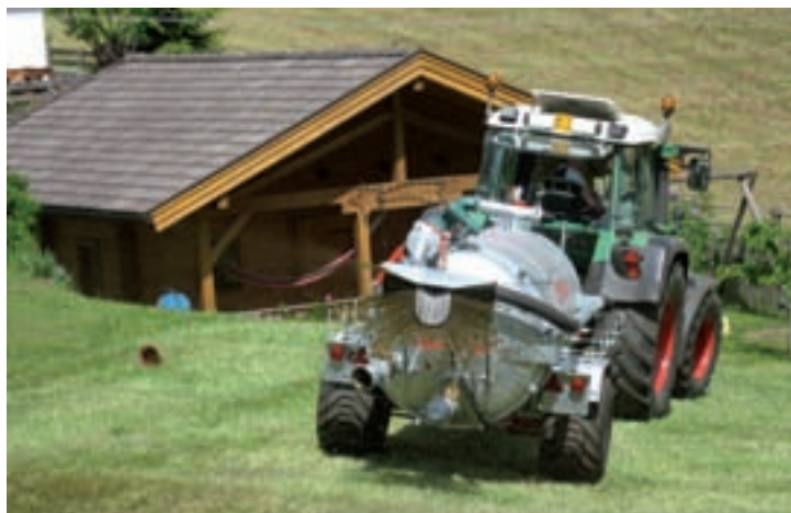
RC 40 Garda beim Güllen mit Exakt-Prallkopfverteiler „Deutschland“
