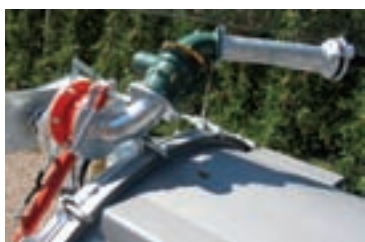
Gülleberegner hydraulisch drehbar und schwenkbar
