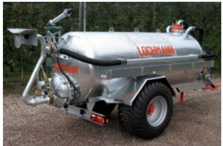
RC 80 Garda mit Exakt-Prallkopfverteiler „Deutschland“
